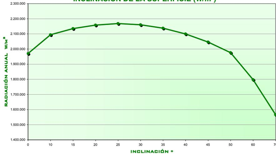
El máximo de irradiación se obtiene al situar los paneles a una inclinación de 25°.
