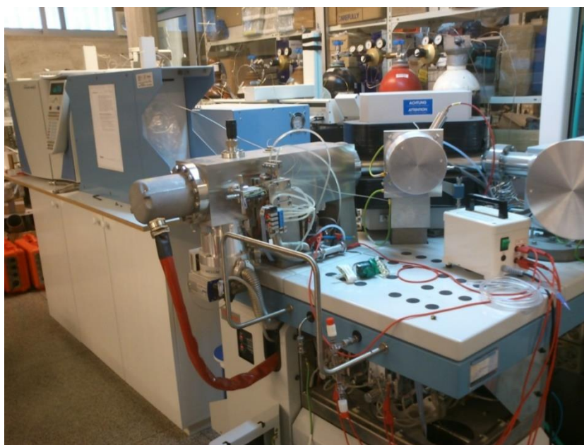
Figura 3.10. Análisis de muestras de gas del suelo por espectrometría de masas de relaciones isotópicas (IRMS).
