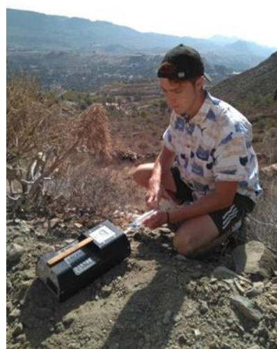
Figura 3.6. Esquema del análisis in-situ de la concentración de vapor de mercurio ( \text{Hg}^0 ) y sulfuro de hidrógeno ( \text{H}_2\text{S} ) en la atmósfera del suelo (izquierda) y medida in situ de \text{Hg}^0 y \text{H}_2\text{S} en la campaña de campo en Gran Canaria (derecha).
