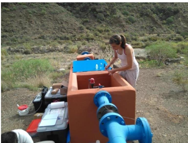
**Figura 3.3.** Toma de muestras de agua para el análisis de gas disuelto.
