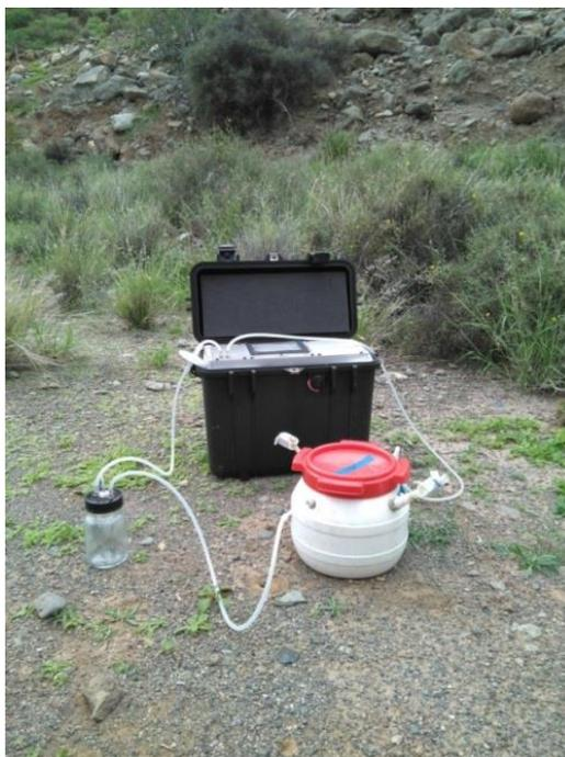
**Figura 3.4.** Espectrómetro Alfa portátil (SARAD RTM 2010-2) utilizado para la medida in situ de la actividad del gas radón ( $^{222}\text{Rn}$ ).
